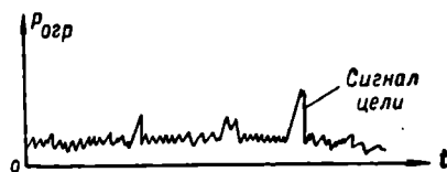
Рис. 1.25. Отраженный сигнал с шумами
