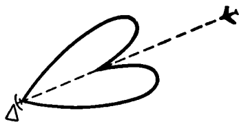
Рис. 1.101. Характеристика направленности антенны при пеленговании по минимуму
