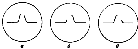
Рис. 1.74. Вид экрана индикатора при различных случаях совмещения «темного пятна» с отраженным сигналом
