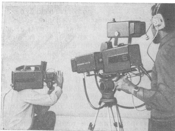
Рис. 2.10. Два варианта использования ТВ камеры LDK-14 фирмы «Филипс»
