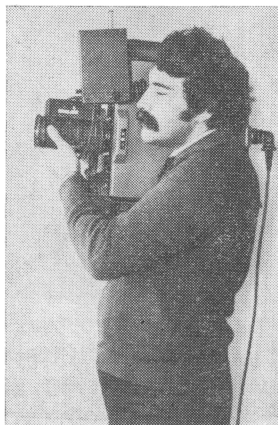
Рис. 2.4. Отечественная репортажная ТВ камера KTR-308
