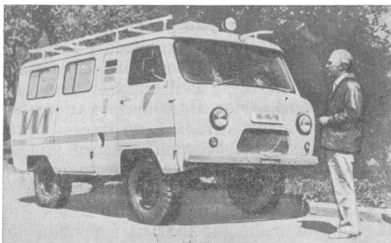
Рис. 4.13. Передвижная репортажная телевизионная станция на базе автомобиля УАЗ-452А
