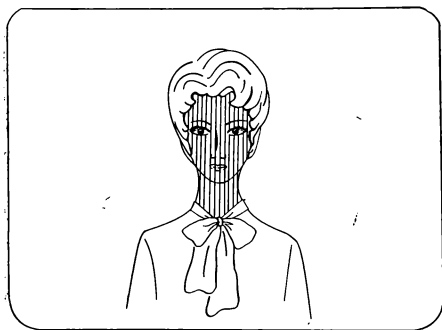
Рис. 2.25. Изображение меток «штриховка» на экране ВКУ ТВ камеры КТР-308
