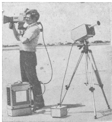
Рис. 1.7. Телевизионный репортаж с прямой передачей информации на телецентр с помощью радиолинии, передатчик которой установлен на треноге
