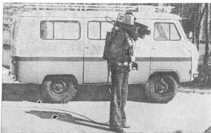
Рис. 2.2. Отечественная репортажная ТВ камера КТ-302Р
