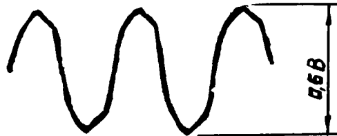
Рис. 56. Форма свободных колебаний модулятора в КТ5
